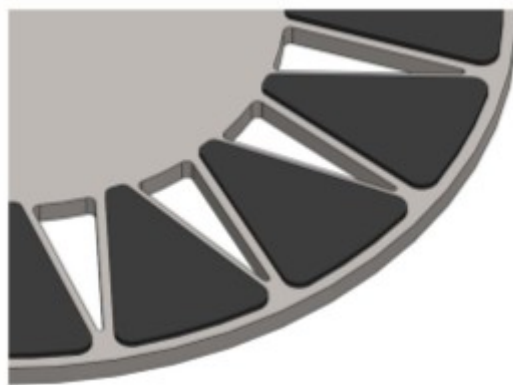
figura 8.15: buchi nella struttura di rotore
