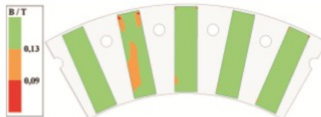
Figura 1.4: distribuzione dell'induzione residua in simulazione con massima corrente di statore
