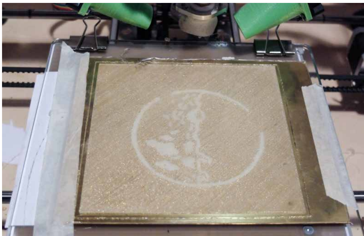
Figura 58_Matrice in TPU con rilievo di geometrie in pasta per piastrelle.
