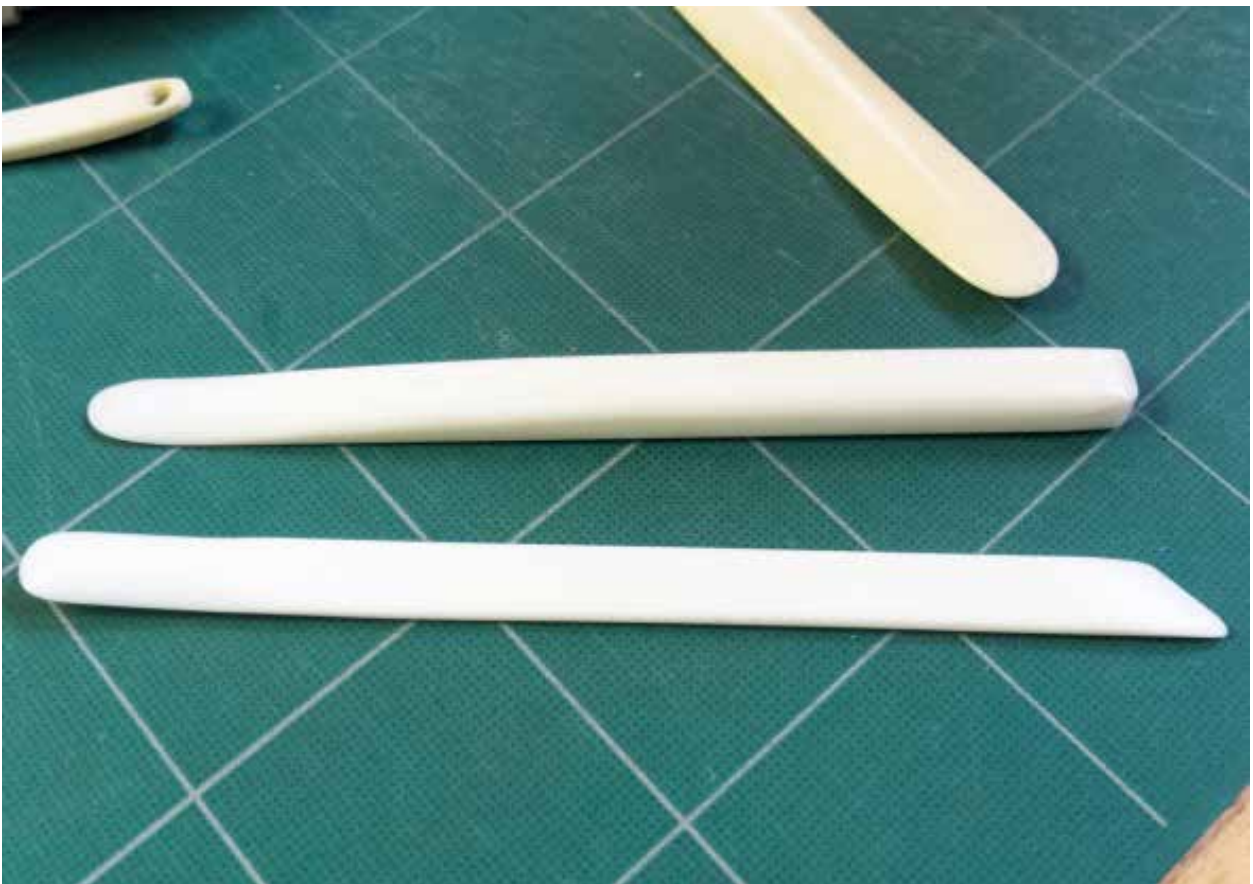
Figura 78_Stecca da restauro tradizionale realizzata in PTFE.
