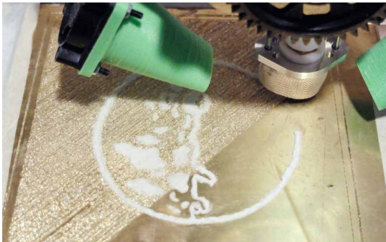
Figura 58_Matrice in TPU con rilievo di geometrie in pasta per piastrelle.
