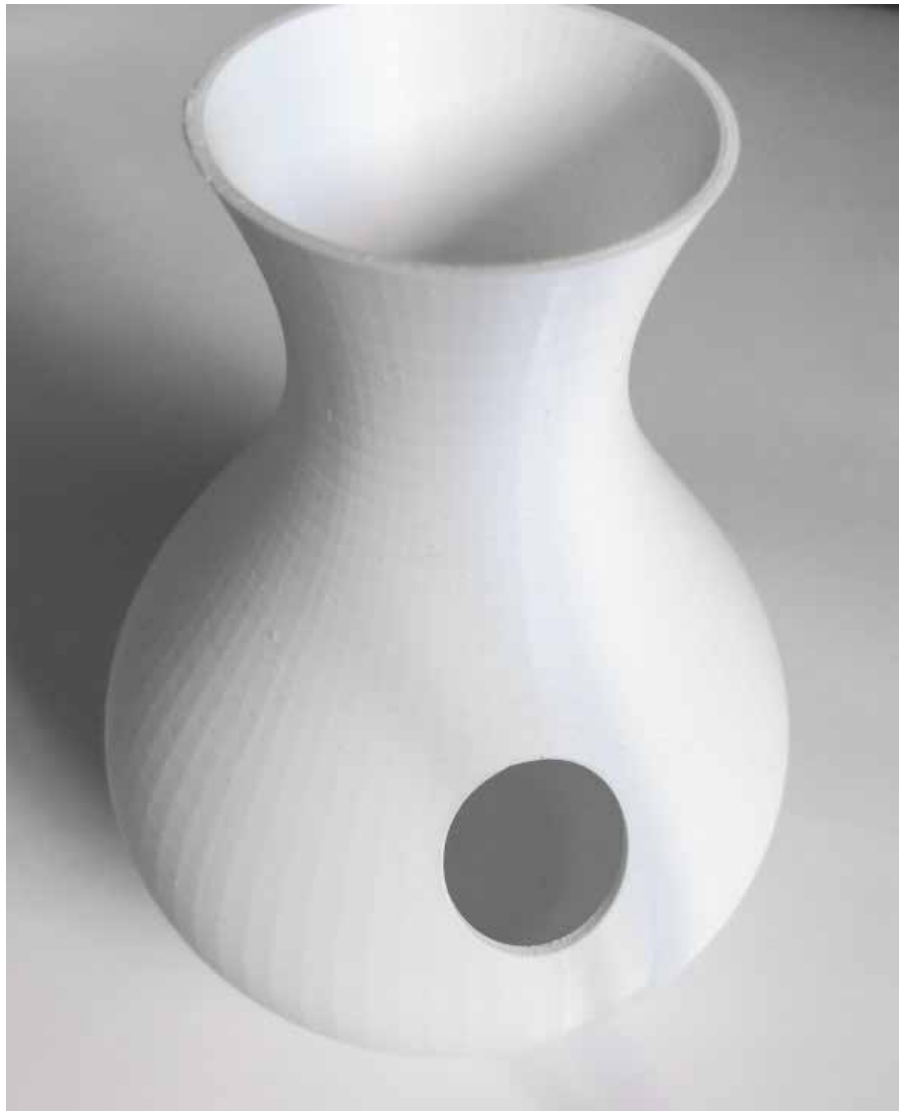
Figura 167_Prova di stampa in PETG.
