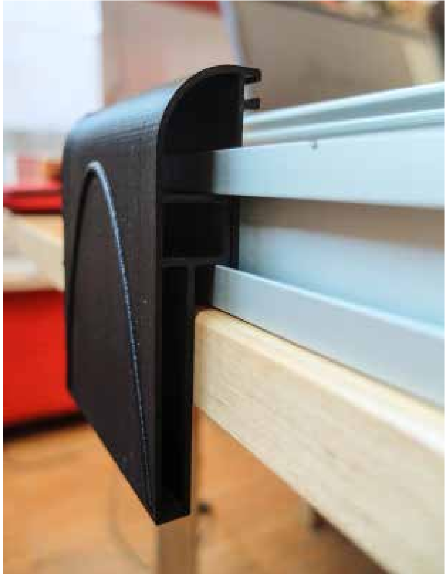
Figura 165_Verifica degli accoppiamenti.
