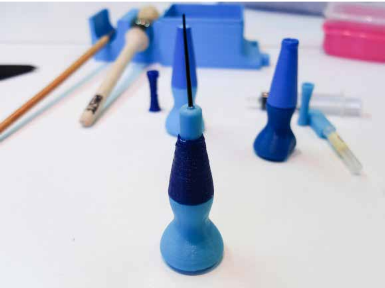
Figura 98_Prima versione stampata 3d con inserto in TPU.
