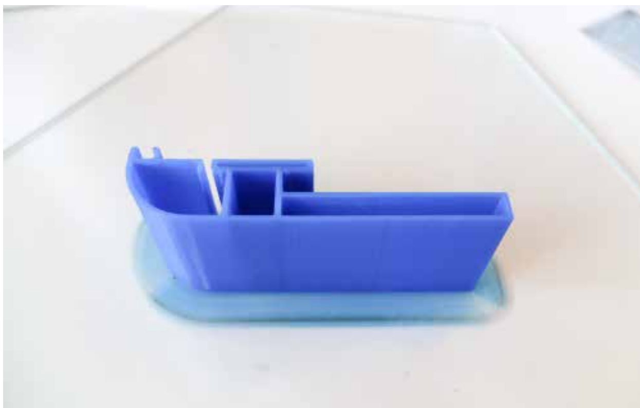
Figura 164_Realizzazione definitivo in ABS.
