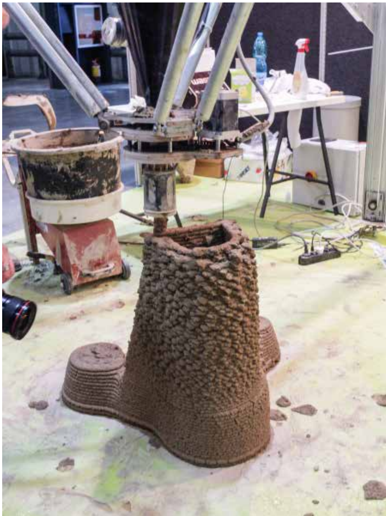
Figura 2_Estrusore WASP presentato alla fiera 3D Print Hub. Milano. 2015.
