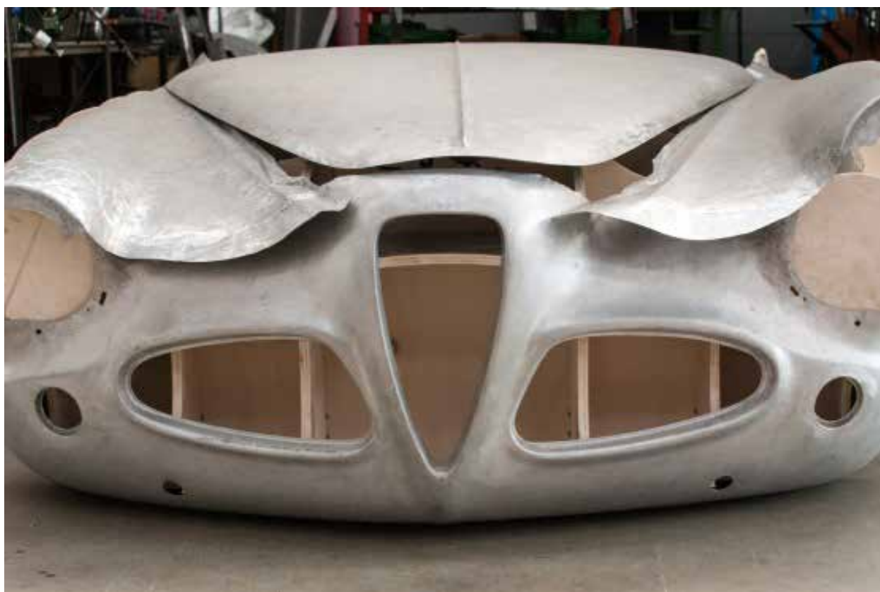
Figura 16_Esempio di struttura su cui vengono modellate le lamiera manualmente. Laboratorio Lopane.
