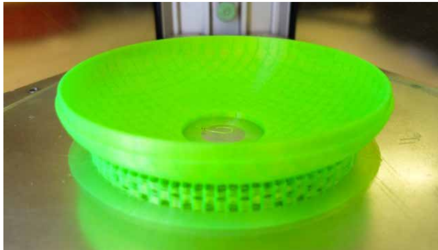
Figura 169_Stampa in scala della versione definitiva in PLA. Coperchio.
