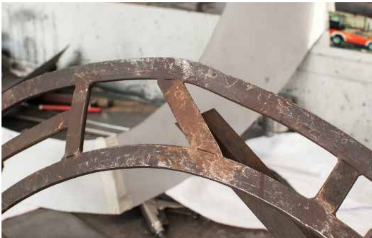
Figura 14_Dime in metallo lavorate a mano. Laboratorio Lopane.
