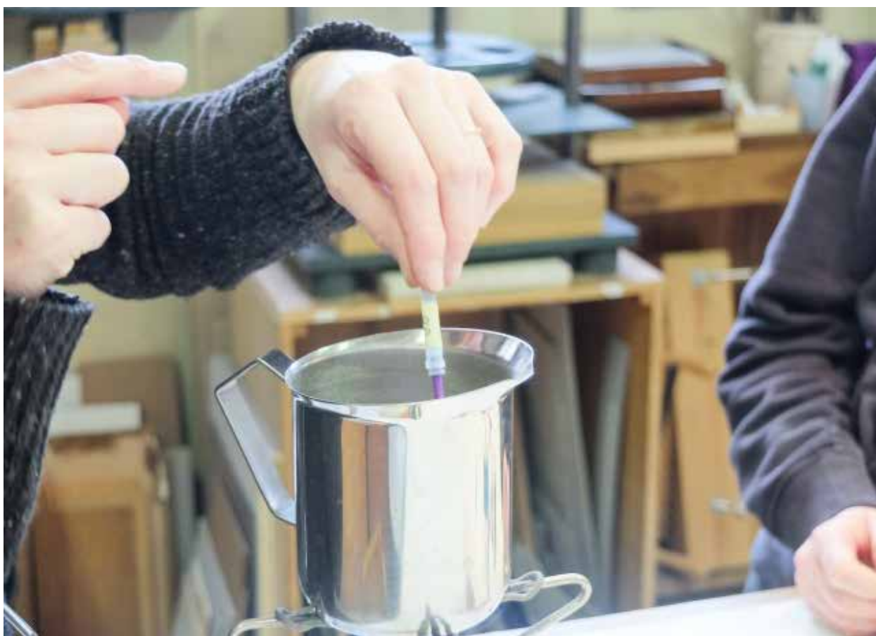
Figura 94_Formatura a caldo del supporto per l'ago.
