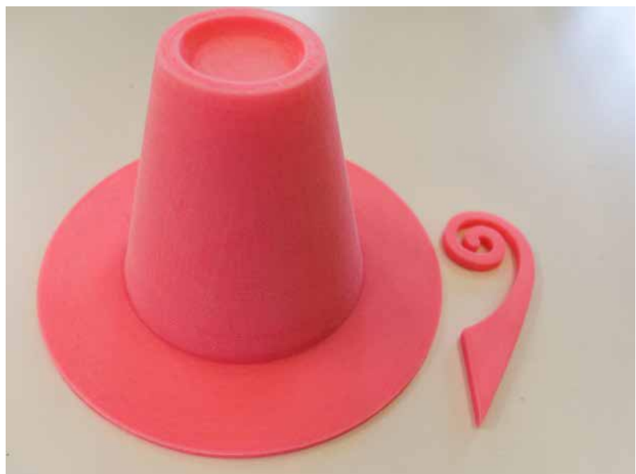
Figura 114_Anime per la realizzazione dello stampo della tazza e del manico.
