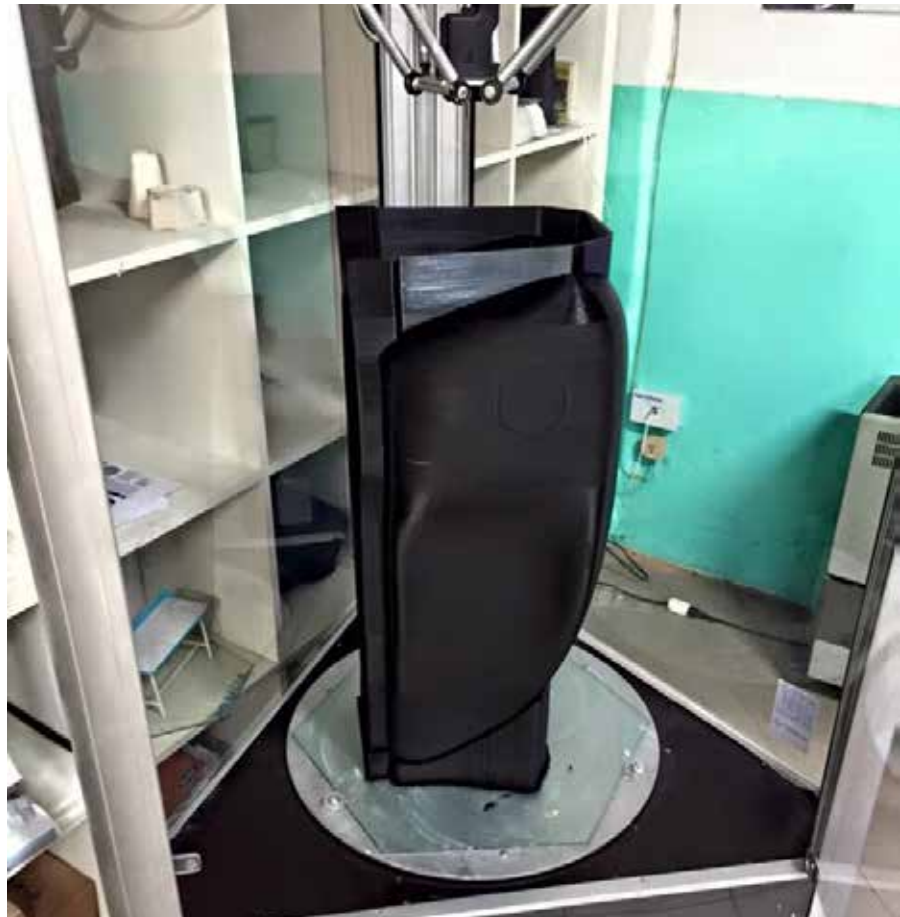
Figura 1_Esempio di stampa 3d fdm applicato all'artigianato. Serbatoio realizzato dalla collaborazione tra l'azienda WASP e l'impresa Tondo Garage. http://www.wasproject.it/w/stampa-3d-e-produzione/ .
