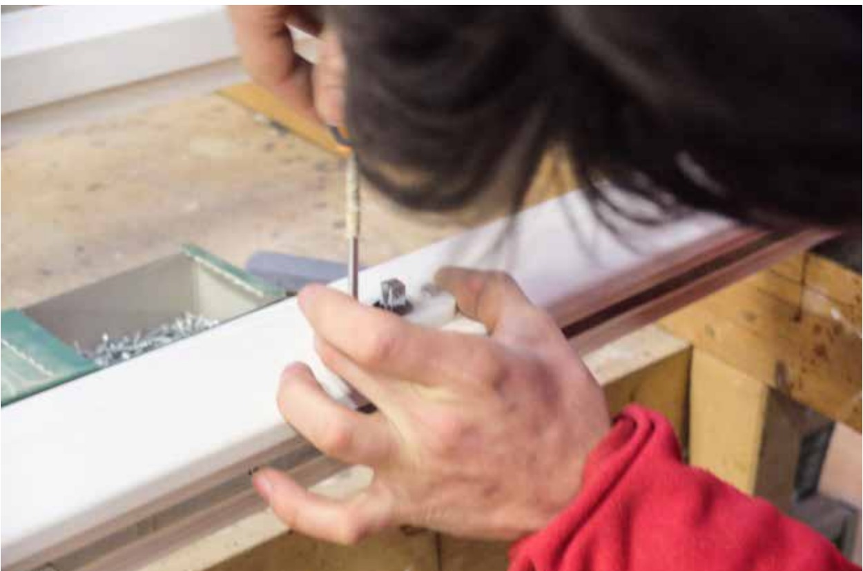
Figura 149_Montaggio del- la maniglia.
