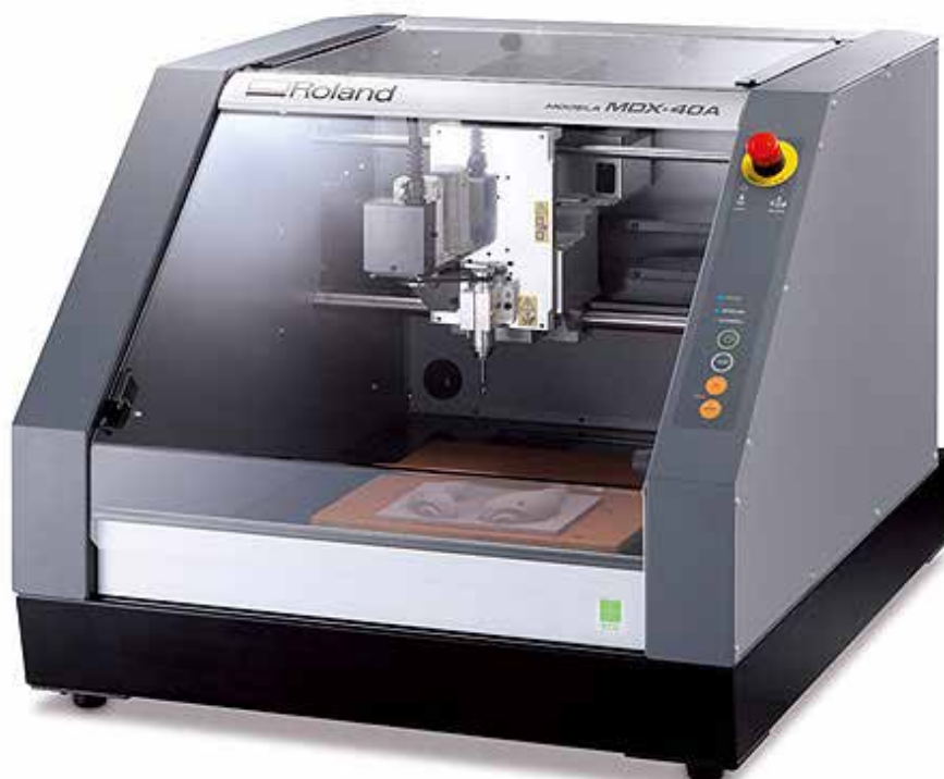
Figura 10_Strumenti digitali all'interno di un FabLab. Esempio di fresa CNC.
