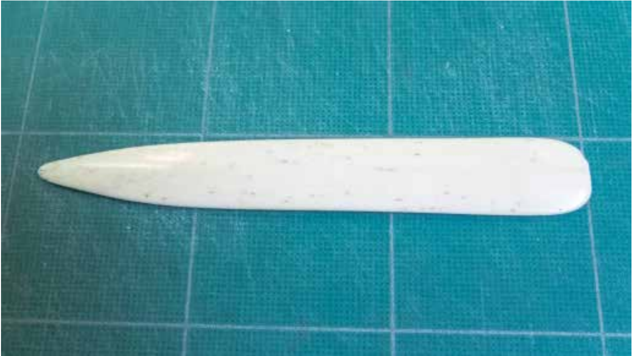
Figura 78_Stecca da restauro tradizionale realizzata in PTFE.
