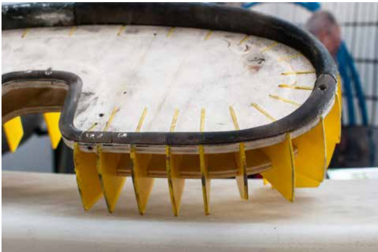
Figura 14_Dime in metallo lavorate a mano. Laboratorio Lopane.
