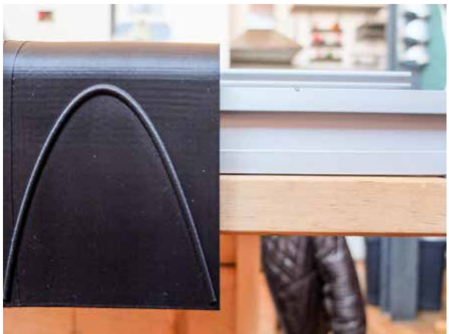
Figura 166_Maschera in ABS montata sull'estruso in alluminio.
