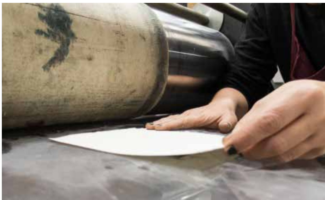
Figura 40_Le fasi del processo di stampa. Posizionamento della matrice. A14.
