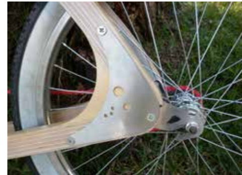
Figura 4.17 - Giunzioni dei forcellini posteriori
