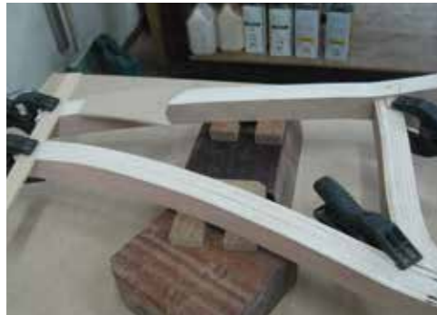
Figura 4.11 - Misura di sagome per la giunzione del telaio
