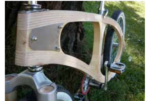
Figura 4.18 - Giunzione anteriore in sandwich
