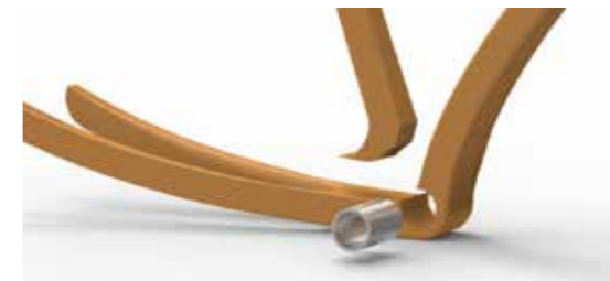
Figura 5.6 - Dettaglio giunzione tubo obliquo, tubo piantone, movimento centrale
