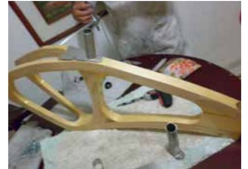
Figura 4.16 - Telaio con verniciatura poliuretantica
