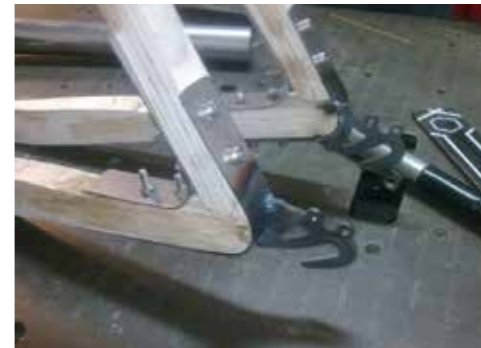
Figura 4.8 - Giunzioni dei forcellini posteriori
