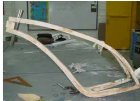
Figura 4.5 - Forma dopo compressione nello stampo
