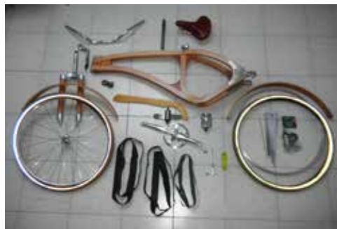
Figura 4.20 - Esplosione di parti per l'assemblaggio
