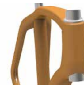
Figura 5.8 - Dettaglio tubo sterzo dentro il telaio
