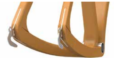
Figura 5.7 - Dettaglio forcelline dentro il telaio
