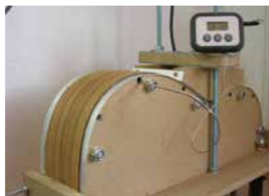
Figura 3.13 - Piegatura a vapore
