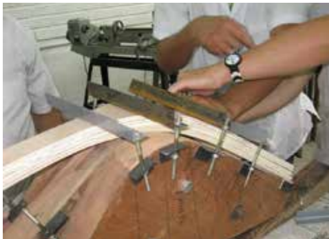
Figura 4.4 - Piegatura di legno tramite lo stampo
