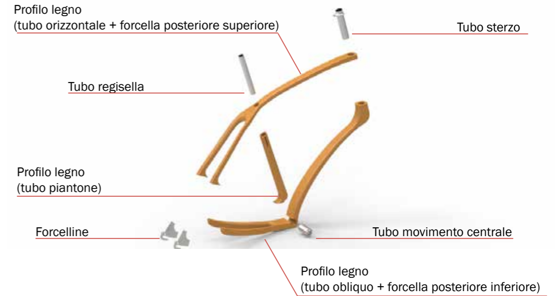
Figura 5.5 - Esploso assieme telaio
