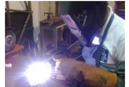
Figura 4.7 - Saldatura TIG dei forcellini posteriori di acciaio
