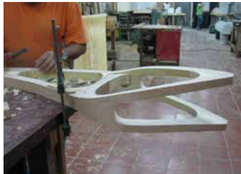
Figura 4.13 - Finitura, prima di verniciatura poliuretantica
