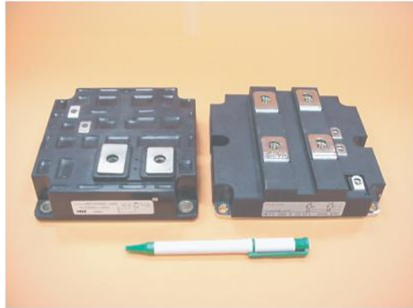
Figura 4.2 – IGBT 1,7 kV/1,2 kA (sinistra) e 3,3 kV/1,2 kA (destra)
