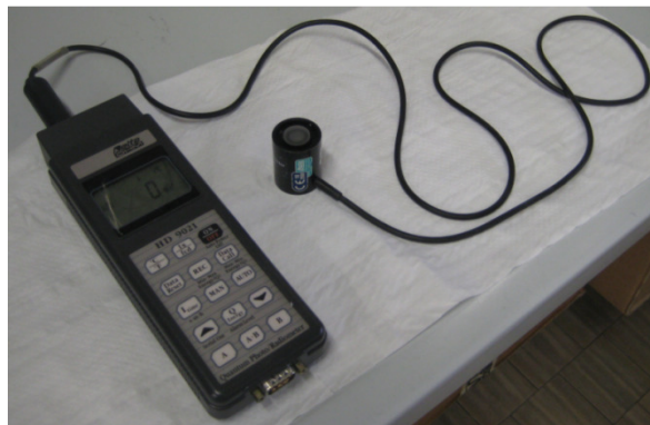
Figura 3.7. Radiometro HD9021 Delta Hom Italy per le misure di intensità radiante
