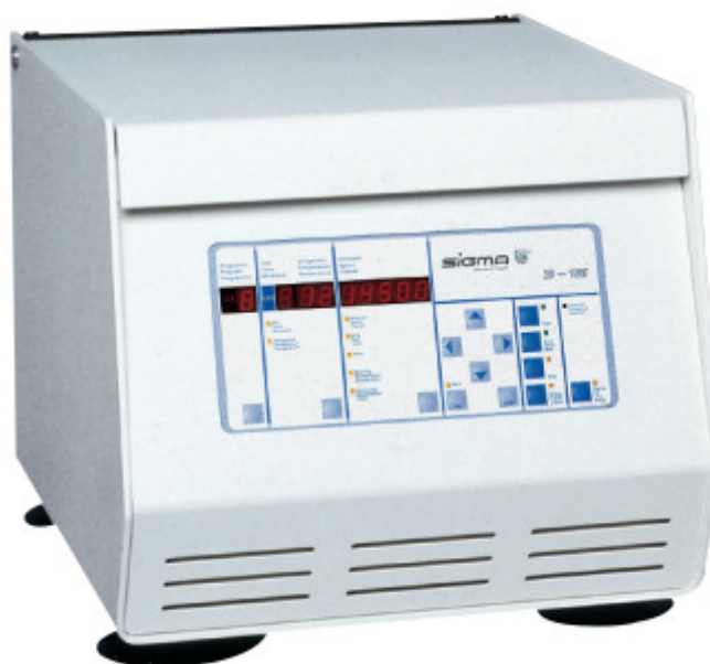
Figura 3.4. Centrifuga Sigma 3K15 utilizzata per la separazione della sospensione di TiO 2 (Sigma-zentrifugen.de)
