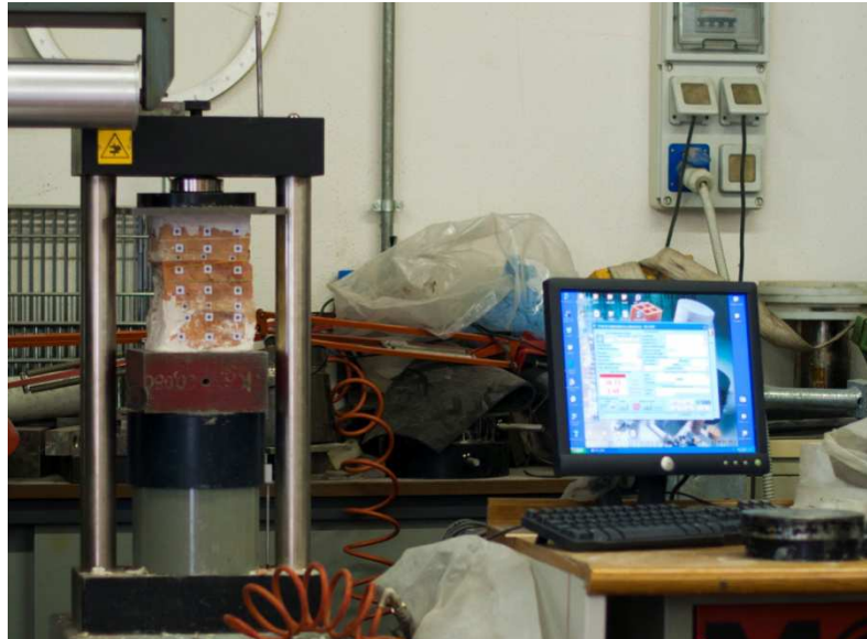
Figura 4.2 – Pressa utilizzata durante le prove a compressione
