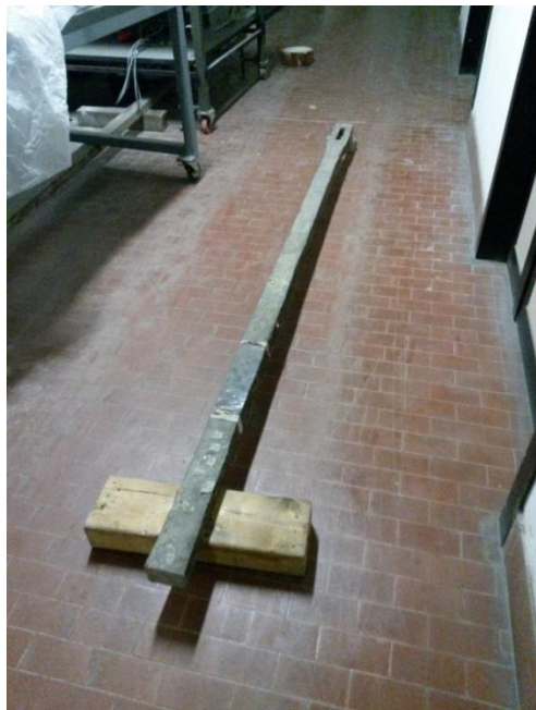
Figura 5. Porzione di una catena metallica a sezione rettangolare proveniente dal Duomo di Milano.
