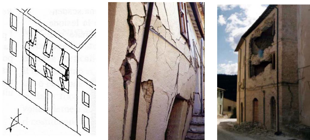
Figura 84. Schema e fotografie del ribaltamento in esame [50].
