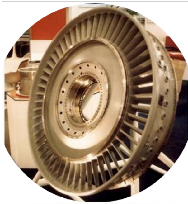
Figura 2: Front Bearing Housing di un generico velivolo
