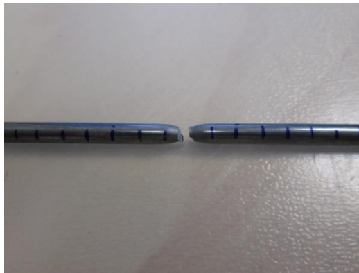
Figura 37 - Esempio di provino rotto di una prova di trazione.
