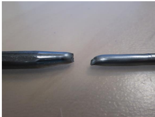
Figura 33 - Ø4.30 rotto durante la trafilatura.
