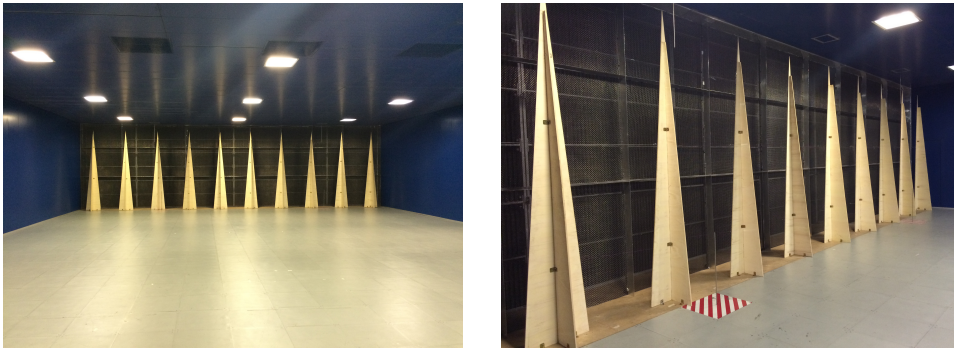
Figura 3.8: Spires per la generazione di turbolenza e wind shear \alpha_{bl} = 0.4
