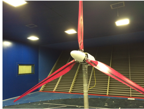
(b) Pale aeroelastiche con BTC
