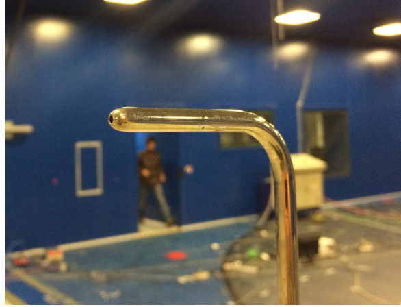
Figura 3.6: Tubo di Pitot
