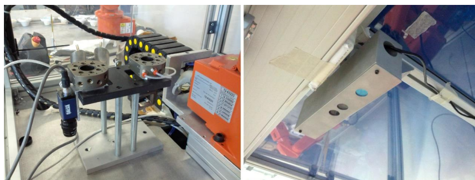
Figura 6-45: Particolari della stazione di cambio utensile (sinistra) e dell'illuminatore (destra).
