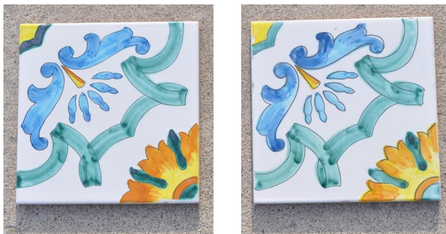
Figura 6-43: Confronto tra una piastrella decorata a mano ed una decorata dal manipolatore IRB 120: decorazione all'interno di contorni.
