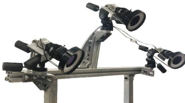
Figura 5-6: Sistema di telecamere utilizzato per le misure.
