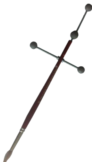
Figura 6-26: Pennello utilizzato per la decorazione manuale a cui sono stati aggiunti quattro marker per permettere le acquisizioni.
