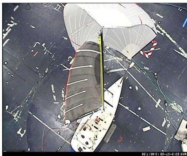
Figura 6-17: Immagine dall'alto dell'imbarcazione durante le prove in galleria del vento.
