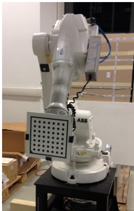
Figura 5-10: Calibratore planare montato in pinza al robot ABB IRB1600.
