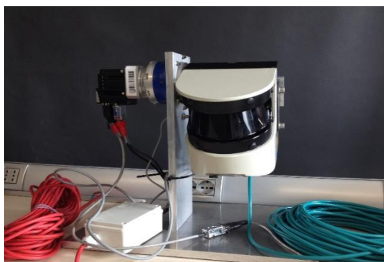
Figura 6-8: Laser scanner (patent application n° PD2014A000249) utilizzato per la scansione delle vele in Galleria del Vento e sulla barca laboratorio LIH (Lecco Innovation Hub).
