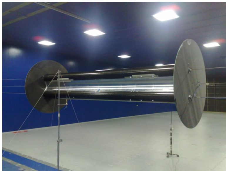
Figura 6-25: esempio di applicazione del sistema stereoscopico alle misure di spostamento del modello di una grossa struttura civile in Galleria del Vento.
