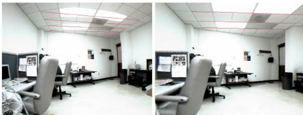
Figura 3-7: Differenza tra un'immagine soggetta a distorsioni radiali (a sinistra) e una non soggetta (a destra).
