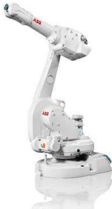
Figura 5-9: Robot antropomorfo ABB IRB1600-6/1.45 utilizzato per le prove di qualificazione metrologica del sistema stereoscopico.
