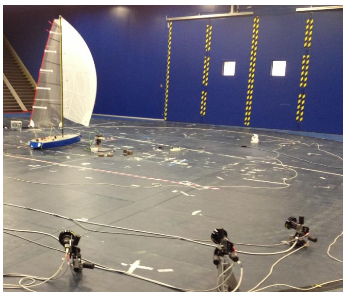
Figura 6-7: Misura della forma della randa di un modello di imbarcazione a vela presso la Galleria del vento
