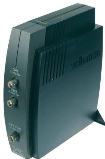
Figura 5-5: Generatore di funzione e oscilloscopio Velleman PCSU 1000, utilizzato per la generazione del segnale di trigger.
