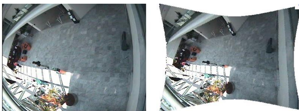
Figura 3-10: Esempio di rettificazione di un'immagine soggetta a distorsioni radiali
