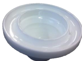
Figura 6-29: Struttura della vasca per il colore attualmente utilizzata nel processo di decorazione a mano.
