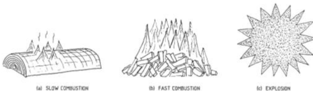
Figura 3: Il tasso di combustione di una data massa di solidi combustibili aumenta con l'aumentare della suddivisione della stessa.
