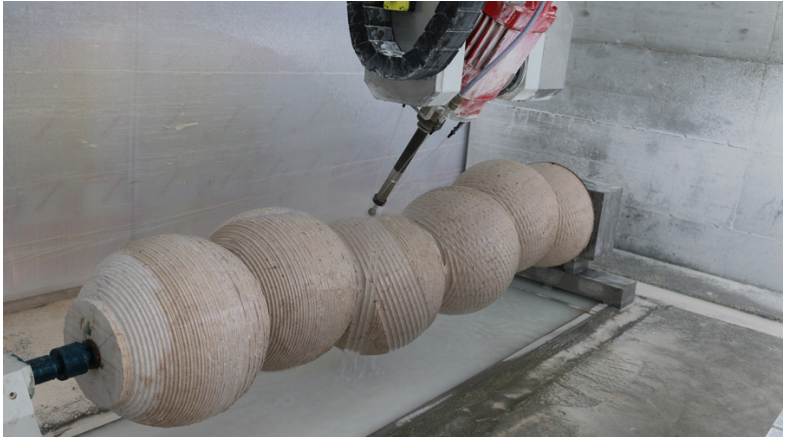
(Fig. 2.1.2_5) Realizzazione oggetto con fresa CNC 5 assi
