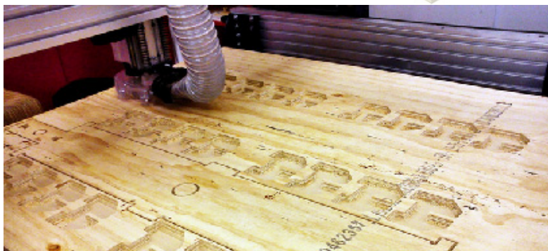
(Fig. 2.3.1_7) Realizzazione pezzi con lavorazione Fresa CNC
