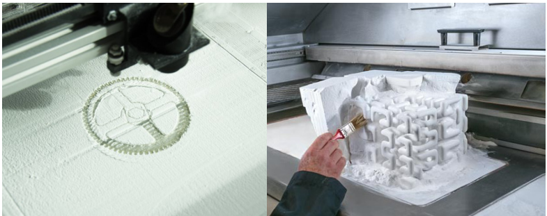
(Fig. 2.1.2_18) Processo di sinterizzazione e prodotto sinterizzato
