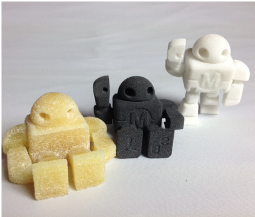
(Fig. 2.1.2_21) Oggetto stampato in zucchero, grafene e nylon con stampante "SnowWhite"
