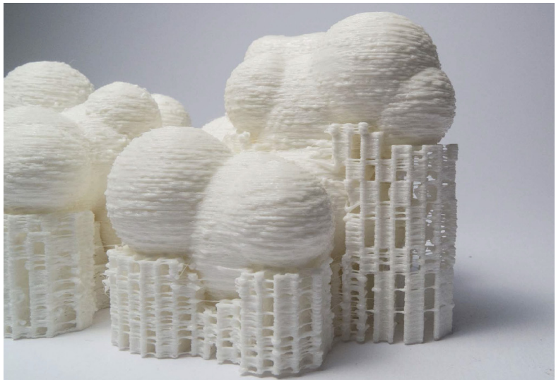
(Fig. 2.1.2_12) Oggetto realizzato in 3D con struttu- ra di supporto.
