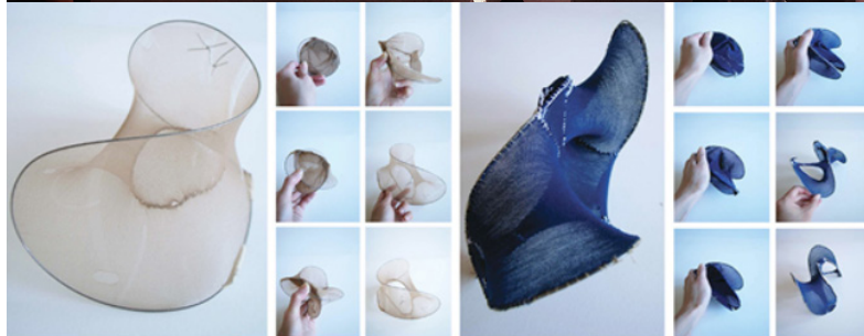
(Fig. 2.3.1_68) Prototipi realizzati in tessuto di nylon e cavo in metallo.
