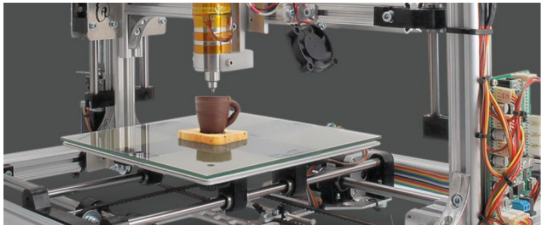
(Fig. 2.1.2_13) Stampante "3Drag" con estrusore di cioccolato
