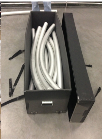
(Fig. 2.3.1_71) Telaio in alluminio sezionato in 24 pezzi
