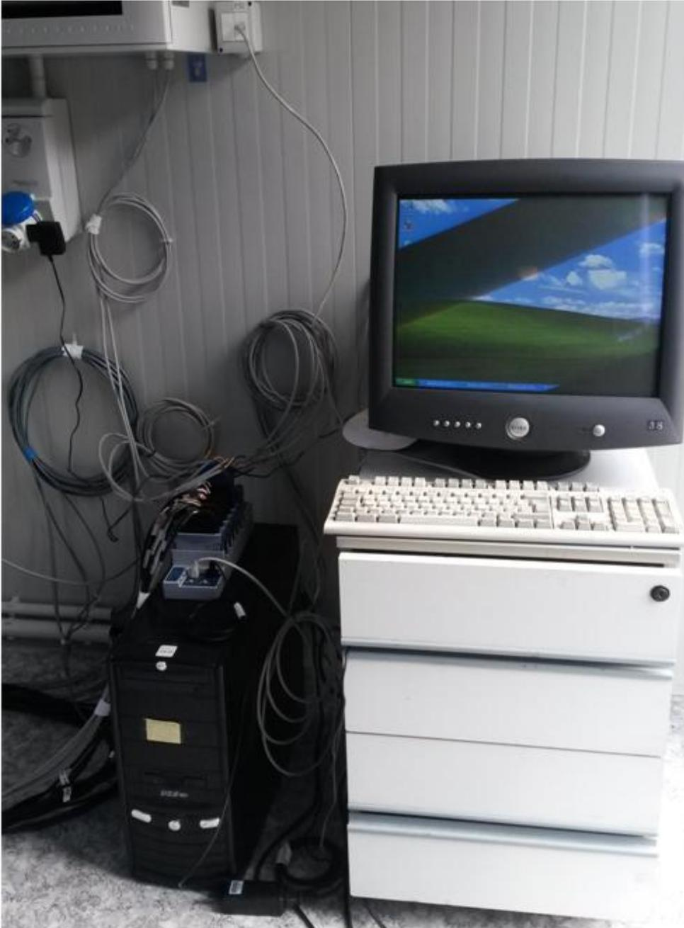
Figura 40. Acquisitore di dati e postazione computer per il monitoraggio remotizzato dei parametri
