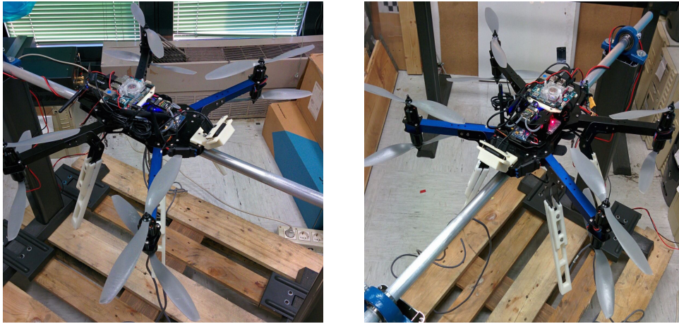
Figura 5.1: Banco di prova per testare il controllo di assetto.
