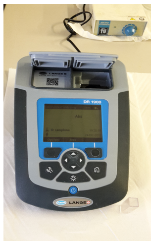
Figura 3.8 Spettrofotometro e cuvetta utilizzati per le misure di assorbanza
