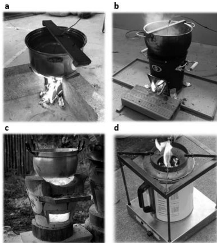
**Figura 1** – Diversi design di stufe migliorate. a) fuoco su tre pietre; b) stufa a legna, modello Rocket; c) stufa a carbone di legna d) gassificatore a circolazione forzata. Le fotografie “a” e “b” sono state scattate dall’autore al Politecnico di Milano – Dipartimento di Energia; la fotografia “d” è stata scattata alla ETHOS Conference 2016.
