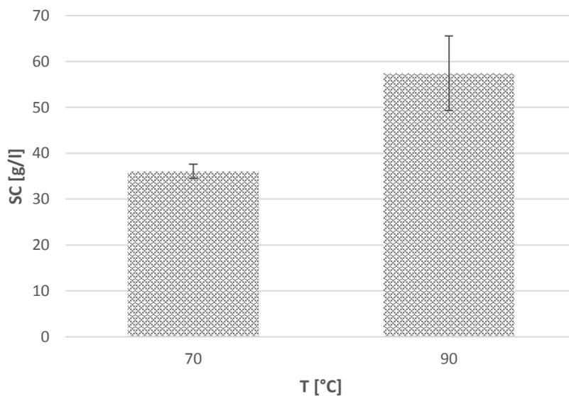
**Figura 5** – Incertezza combinata a diverse temperature, relativa alla Specific fuel Consumption (SC) ed estesa per un L.C. del 95%. Le barre rappresentano la dev.std.
