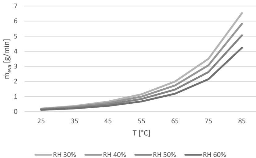
**Figura 3** – Variabilità del tasso di evaporazione in funzione dell’umidità relativa.
