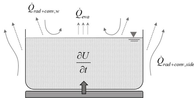
**Figura 4** – Schema rappresentativo del bilancio termico del sistema considerato.
