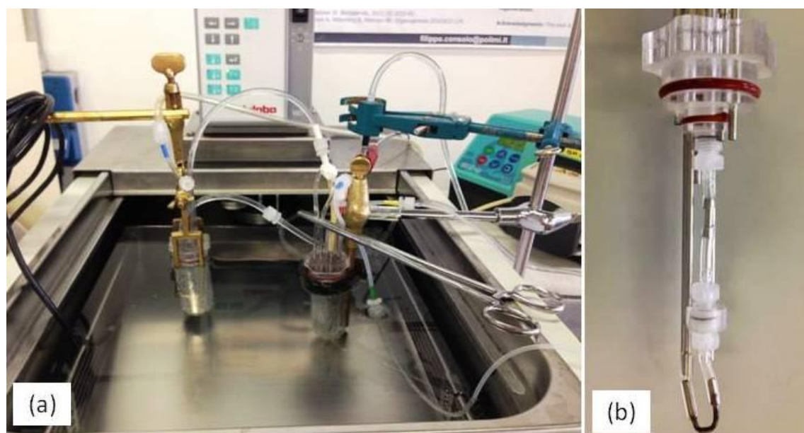
Fig. 3.13: Setup sperimentale messo a punto per verificare le previsioni del modello (a) Utilizzo di clamp vascolari per eliminare sperimentalmente il contributo dei tubi del “troppo pieno” e del filtro HEPA; (b) sostituzione del silicone presente all’interno della camera avventiziale con cannule metalliche e tubi in PVC per estromettere ogni collegamento tra i due compartimenti ed escludere quindi tutte le possibili sorgenti di ossigenazione della camera avventiziale .
