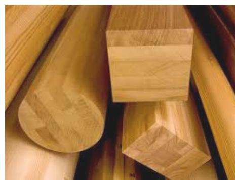
Fig.9.35 Sezioni in legno lamellare
