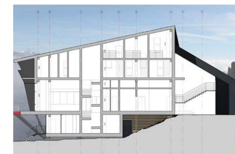
Fig.7.22 Sezione che mostra le diverse altezze di interpiano
