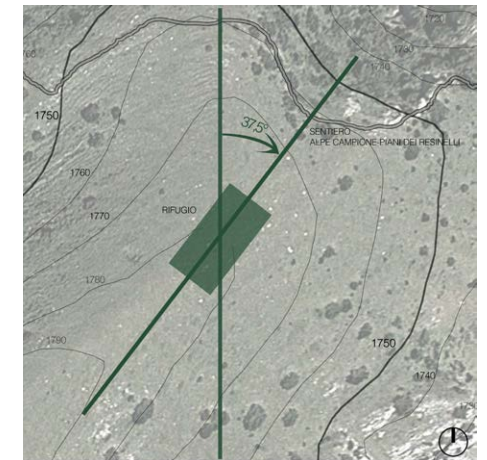
Fig.7.5 Disposizione dell'asse principale dell'edificio a 37,5° orari rispetto al Nord
