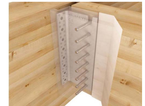
Fig.9.57 Staffa a scomparsa tipo ALUMIDI fissata con chiodi e bulloni con dado
