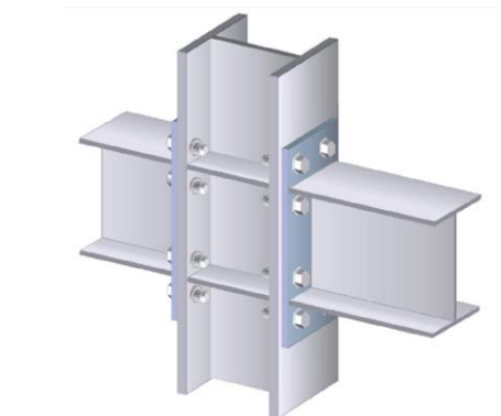
Fig.9.82 Giunto flangiato con piatto esteso oltre al filo trave (vincolo ad incastro)
