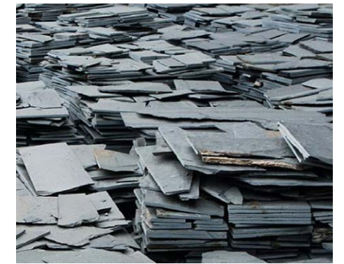
Fig.7.41 Materiale pietra scartato per l'eccessivo peso e tempi di posa elevati
