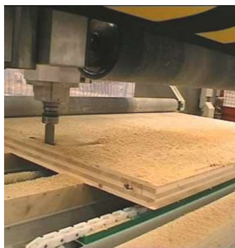
Fig.9.11 Prefabbricazione del pannello X-lam in stabilimento
