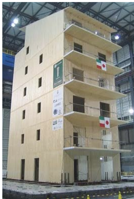
Fig.9.14 Test sismico su edificio in X-lam di 7 piani realizzato a Miki (Giappone)
