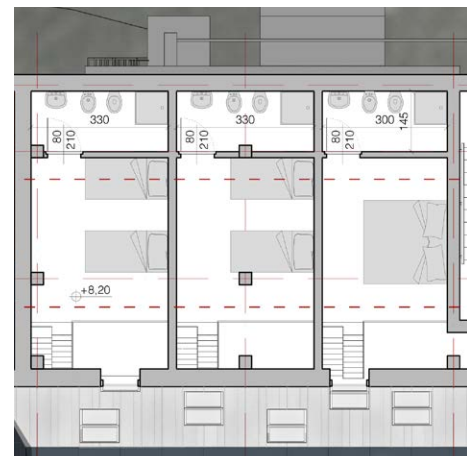
Fig.7.27 Soppalco: dettaglio dell'appartamento del gestore e delle camerate da 10 persone
