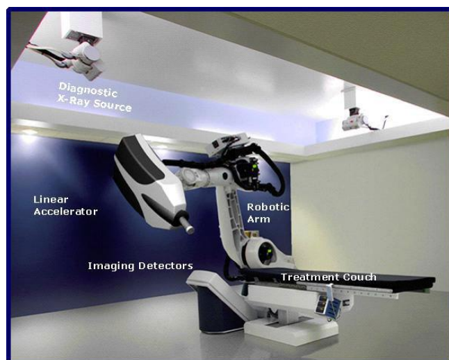
Figura 3.15: Sistema CyberKnife , con evidenziati i componenti principali.
