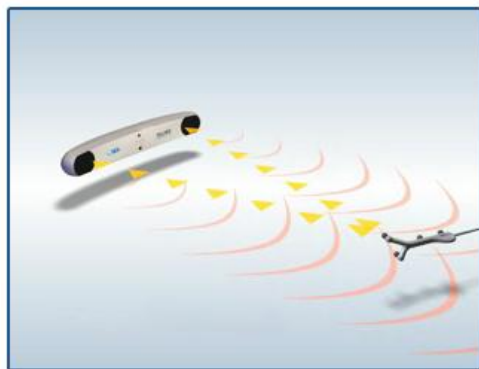
Figura 3.4: Rappresentazione schematica del funzionamento di un sistema di localizzazione ottica con marcatori riflettenti.
