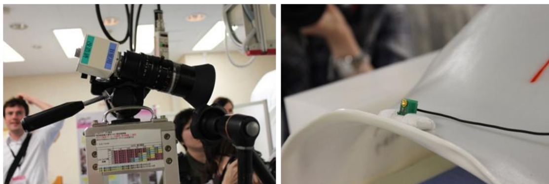
Figura 3.8: Telecamera e sensore utilizzati per il gating respiratorio presso HIMAC.
