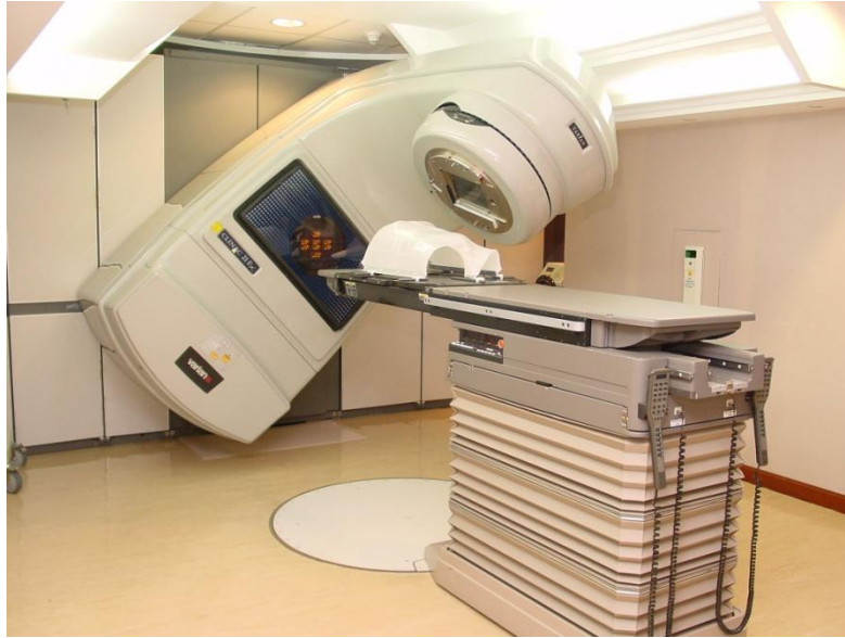
Figura 2.10: Acceleratore lineare con gantry isocentrico.
