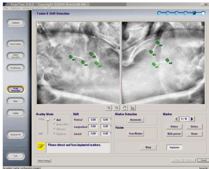
Figura 3.1: Schermata del software di gestione del trattamento, in cui si osservano i reperi radiopachi impiantati nel bersaglio (in questo caso, la prostata).
