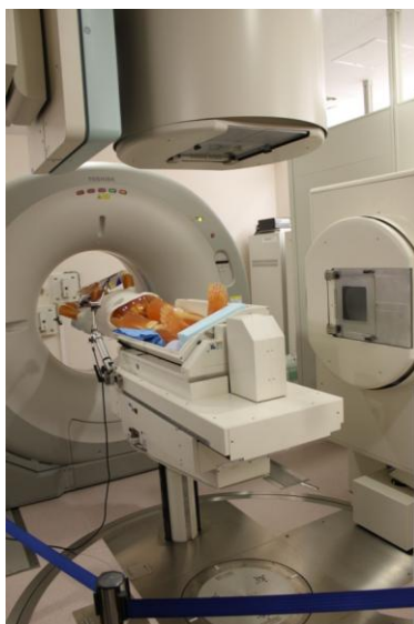
Figura 3.7: sistema di IGHT presso al GHMC. Si notano lo scanner CT e il lettino robotico.
