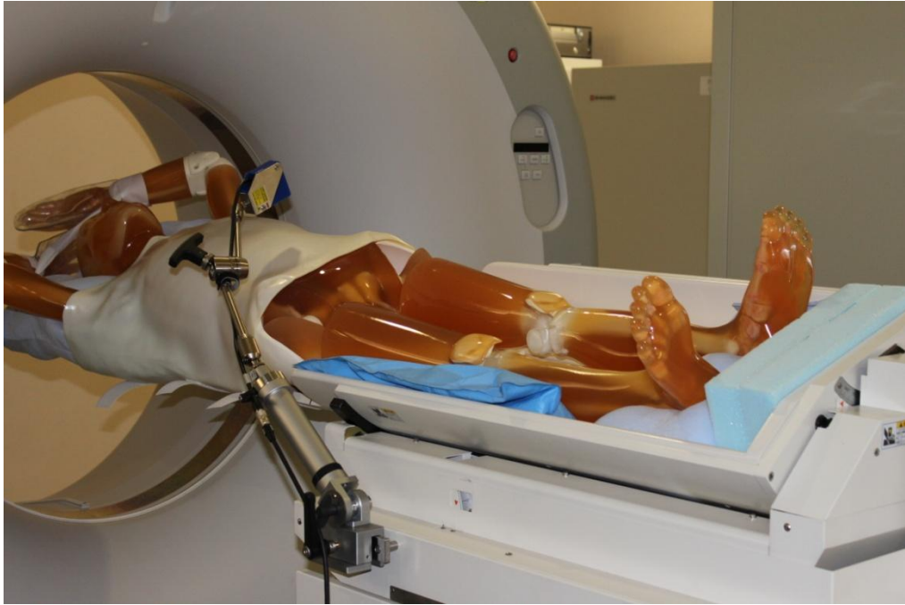
Figura 3.9: Dispositivo per il gating respiratorio utilizzato presso GHMC.
