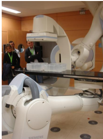
Figura 3.6: Sala di trattamento presso l'HIT. Sono visibili sia il sistema di posizionamento robotizzato sia l'arco a C.
