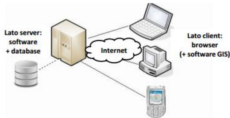
Figura 4.1 -Componenti dell'architettura client/server (F. Migliaccio,2016).
