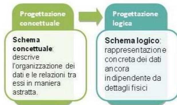
Figura 2.1- Le due fasi della progettazione del DB
