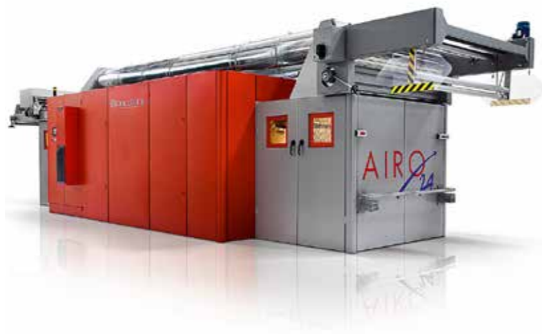
98. Performance e produttività con AIRO 24 di Biancalani, tumbler continuo per asciugatura e ammorbidimento in largo per tutti i tessuti a navetta, maglia, e non tessuti.
