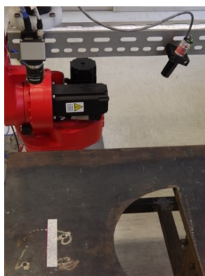
Figura 4.4: Prototipo sistema di misura: dettaglio camera eye-in-hand
