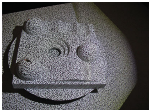
Figura 2.5: Esempio di pattern statico proiettato da strumenti a triangolazione con luce strutturata[14].
