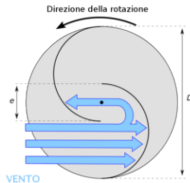
Figura 4.3: Principio di funzionamento turbina Savonius [9]
