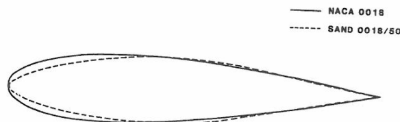
Figura 8.13: Confronto tra geometria NACA0018 e SANDIA 0018/50 [34]
