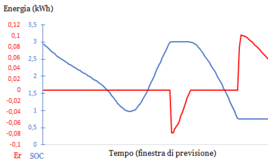
Figura 4.16 Andamento dell'energia prelevata/ immessa nella rete ( E_r ) e dell'energia immagazzinata nelle batterie (SOC). (dicembre 2015, SOC_0 = EC )
