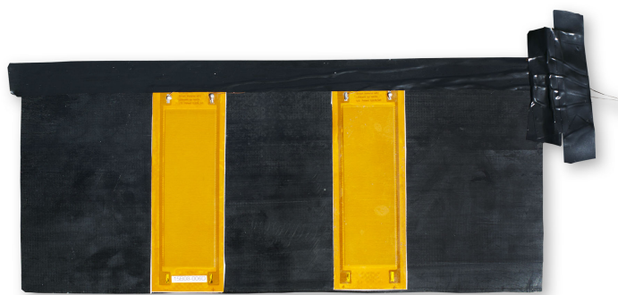
Figura 5.6: Piastra di carbonio con MFC incollati su un lato, prima di essere montata sul bordo di uscita di un profilo.
