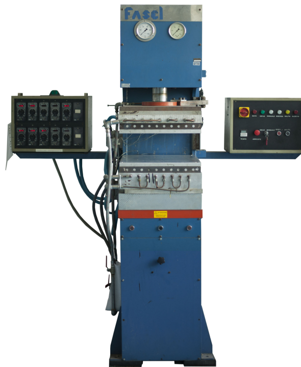
Figure 4.5: Press used at DAER (Dipartimento di Scienze e Tecnologie Aerospaziali, Politecnico di Milano) material laboratory to laminate the plates.
