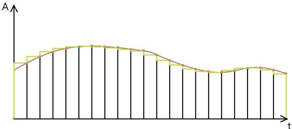
Figura 28 – Quantizzazione di un segnale campionato
