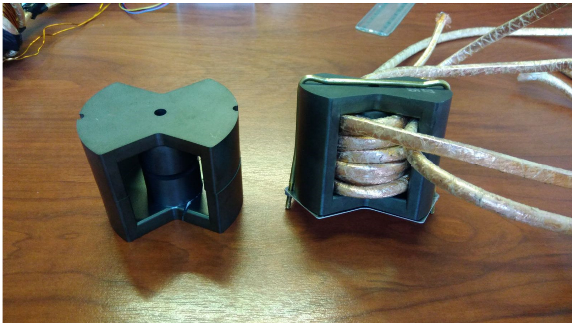
Figura 98, foto dell'induttore: core e induttore avvolto
