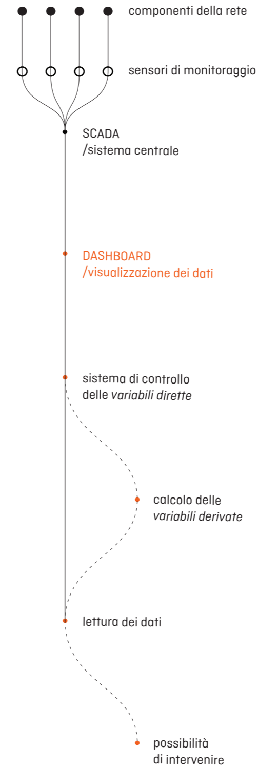
fig. 12 funzionamento del sistema di visualizzazione attualmente in uso per il monitoraggio della rete
