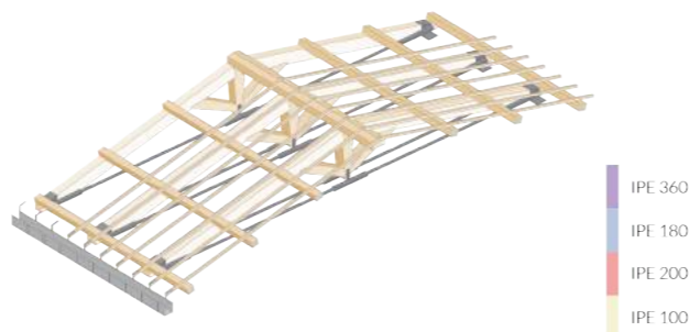
SOLAIO_ Struttura a telaio in acciaio
