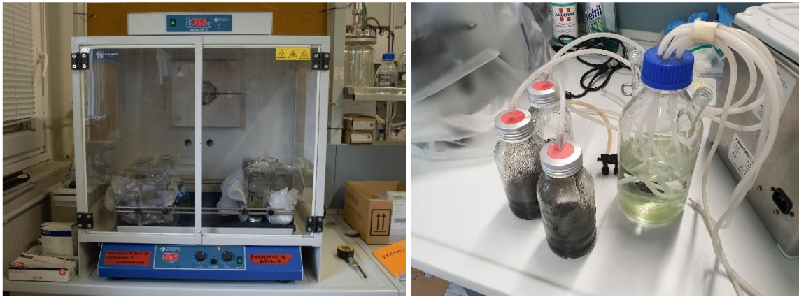
Figura 5.8 – Termostato con bottiglie incubate (a sinistra) e sistema di sfiato (a destra).
