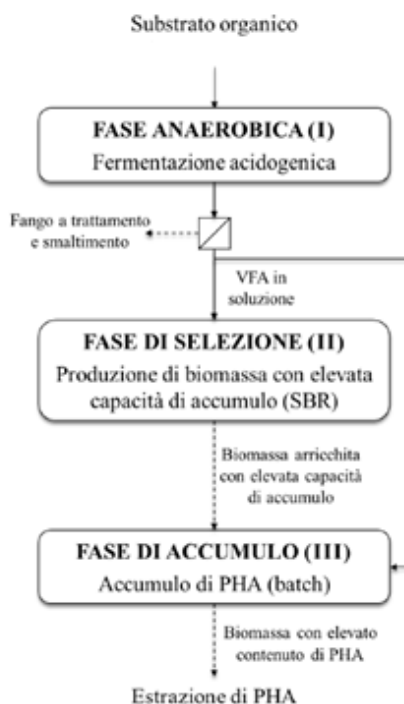
FIGURA 2.4 - RAPPRESENTAZIONE SCHEMATICA DEL TIPICO PROCESSO A 3 FASI UTILIZZATO PER LA PRODUZIONE DI PHA TRAMITE MMC (ADATTATA DA REIS ET AL. 2011). LE LINEE CONTINUE RAPPRESENTANO FLUSSI LIQUIDI, QUELLE TRATTEGGIATE I FLUSSI DI BIOMASSA.
