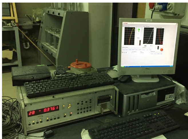
Figura 3.17: Centralina e computer impiegati per l'acquisizione dei dati
