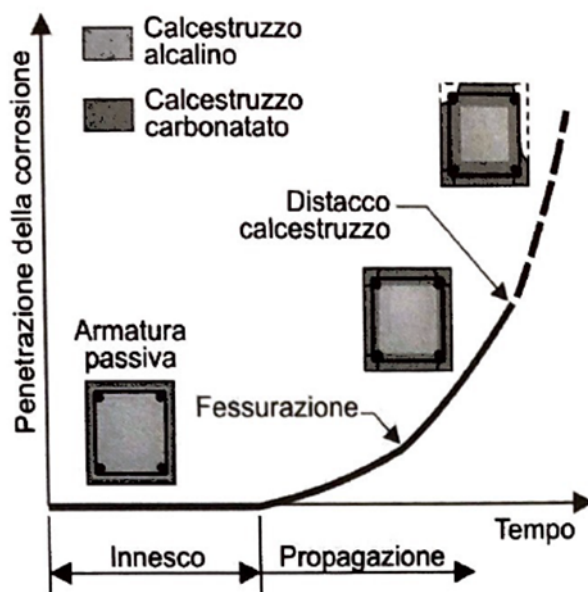
Figura 2.10: Evoluzione della carbonatazione nel tempo [5].
