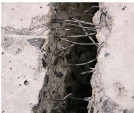
Figura 2.39: Fibre metalliche in calcestruzzo fibrorinforzato
