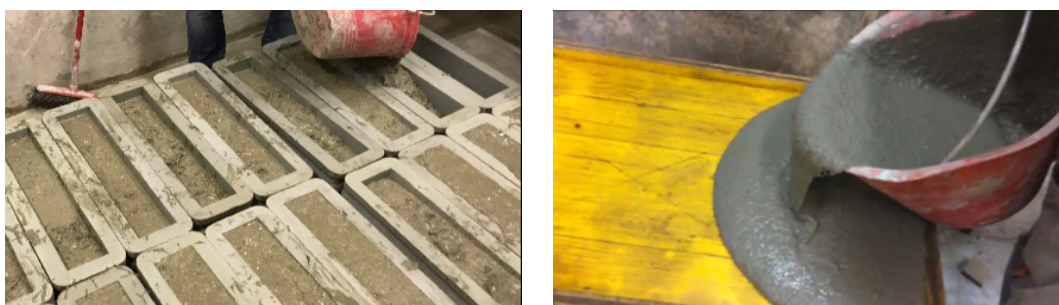
Figura 3.4: Getto di un travetto (sinistra) e di una lastra (destra).
