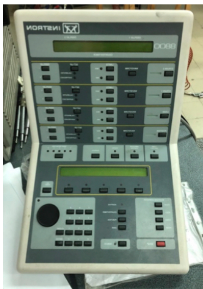
Figura 3.14: Quadro di controllo della pressa elettromeccanica INSTRON
