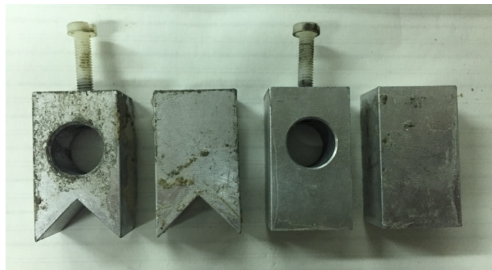
Figura 3.15: Sostegni necessari per l'utilizzo degli LVDT
