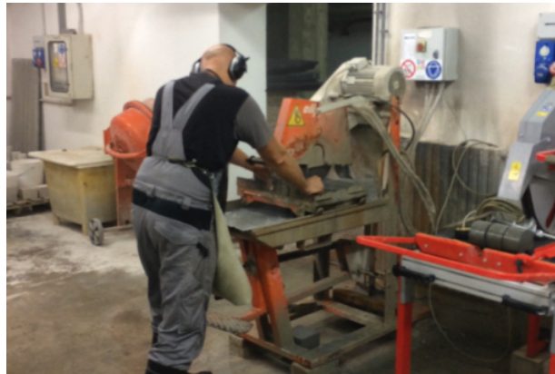
Figura 3.8: Operatore occupato al taglio dei cilindri con clipper Major (NORTON)
