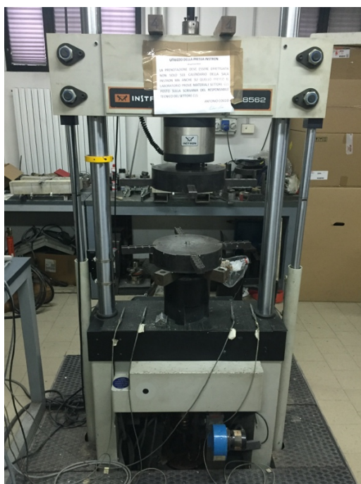
Figura 3.13: Pressa elettromeccanica INSTRON 8562 del Laboratorio Prove Materiali Strutture e Costruzioni del Politecnico di Milano.
