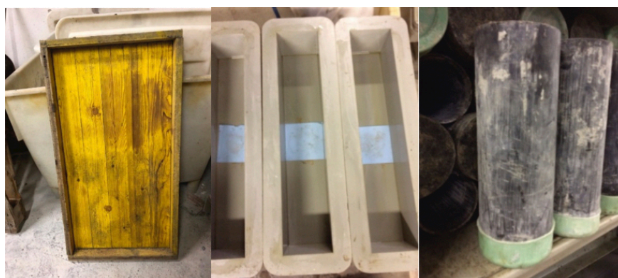
Figura 3.3: Tipologie di casseri utilizzati. A partire da sinistra: Lastra, Travetti e Cilindri.
