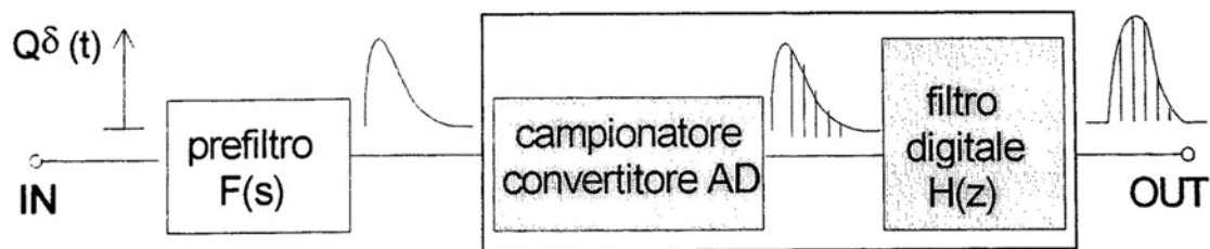
Figura 1 - 10: Versione digitale del sistema di filtraggio a linee di ritardo multiple (DL) Rispetto alla versione la sezione di campionamento è stata anticipata.
