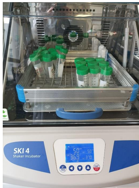
Figure 19: falcon contenenti i campioni inseriti nello Shaker Incubator per il test di degradazione
