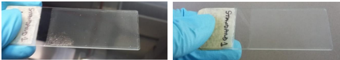
Figure 38: rivestimenti ottenuti tramite un'immersione nella soluzione NI_SI prima e dopo 25 giorni all'interno della stufa a 37°C
