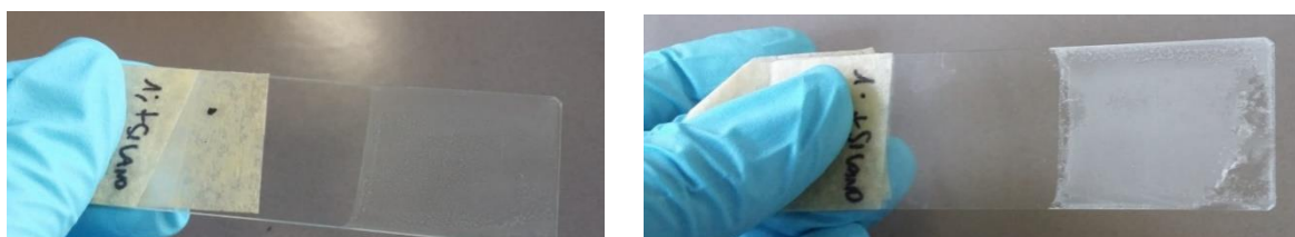
Figure 36: rivestimenti ottenuti tramite un'immersione nella soluzione CA_S prima e dopo 42 giorni all'interno della stufa a 37°C
