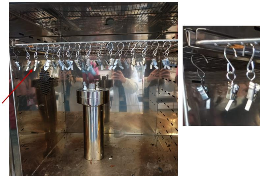
Figure 17: sistema di mantenimento dei campioni nel forno a 160°C
