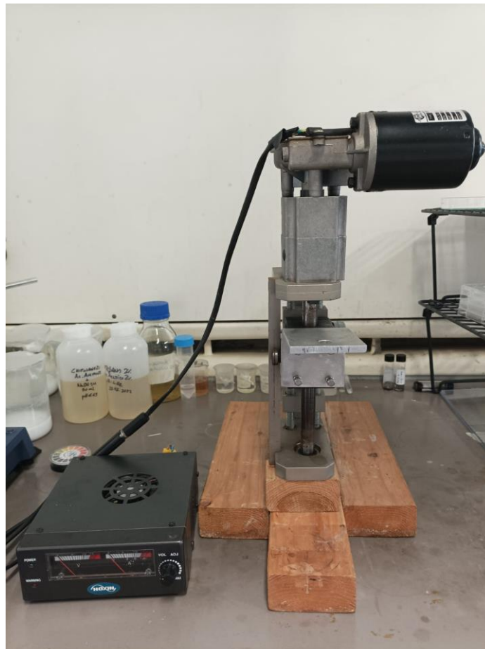
Figure 14 : apparato sperimentale per il Dip-Coating
