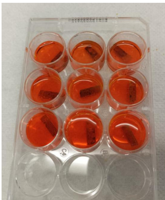
Figure 20: immersione dei provini in triossido di cromo \text{CrO}_3
