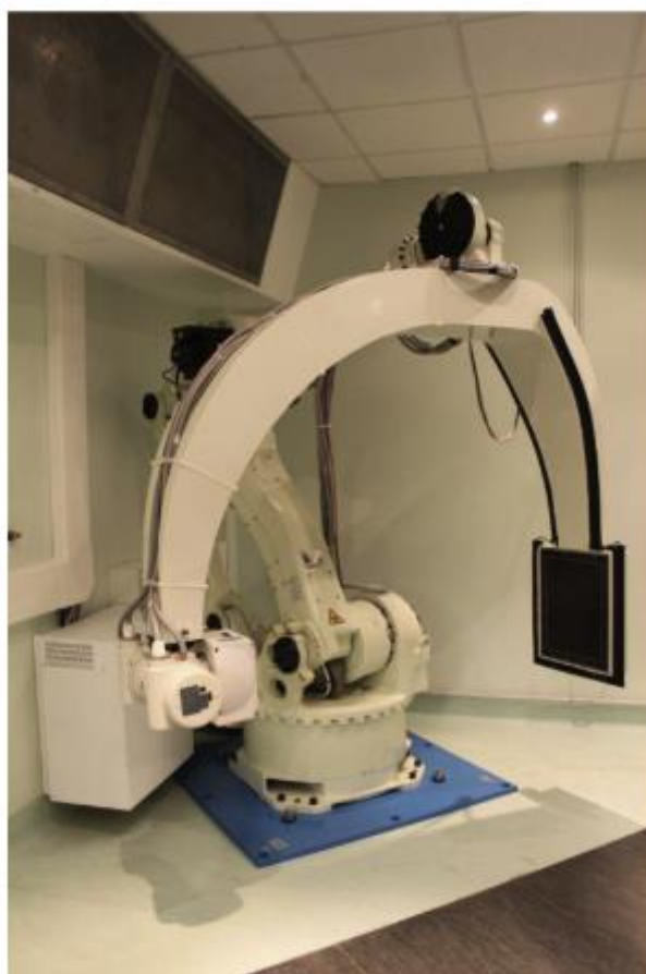
Figura 2 Il sistema custom robotico di in-room imaging installato nella sala centrale di CNAO.
