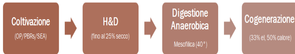
Figura 36: Scenario 1: digestione anaerobica e produzione di elettricità
