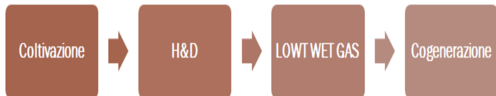
Figura 39: Scenario 4: gassificazione umida a bassa temperatura e produzione di elettricità
