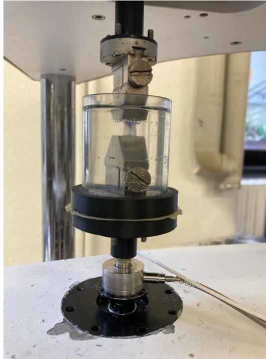
Figura 5.2: Set up sperimentale con campione di sclera.
