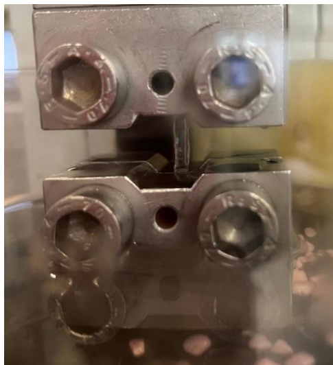
Figura 5.9: Dettaglio degli afferraggi e campione corneale montato all'interno del set up.
