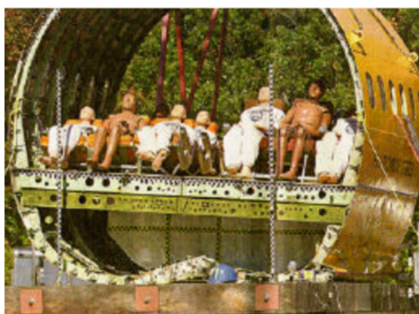
Figura 8.10: Sezione di prova di un Boeing 737-200 dopo il drop test (Crash Simulation of a Boeing 737 Fuselage Section Vertical Drop Test, Figura 3)
