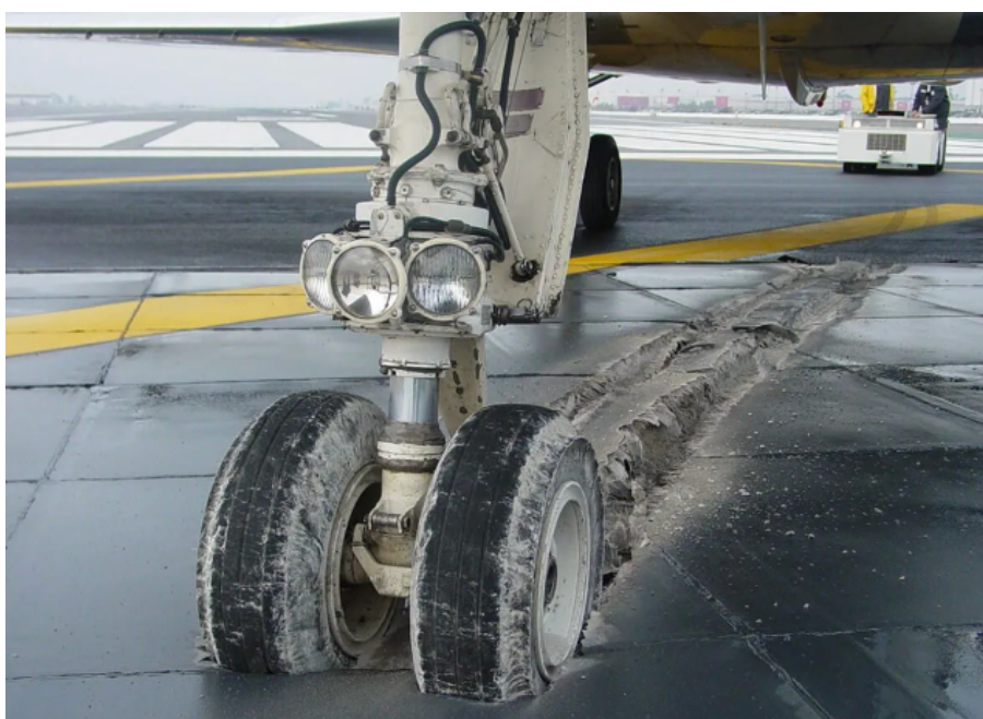
Figura 3.2: Affondamento del carrello principale nel letto d'arresto EMAS [24]
