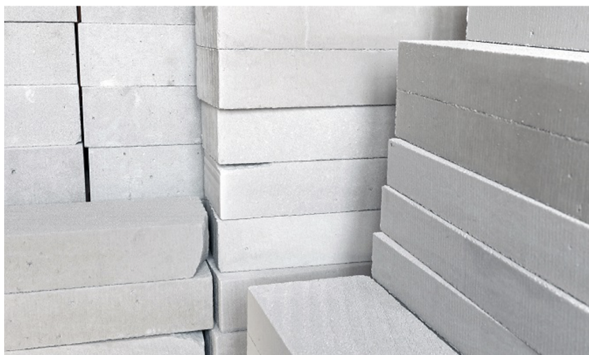
Figura 6.1: Blocchi di calcestruzzo cellulare a bassissima densità [8]
