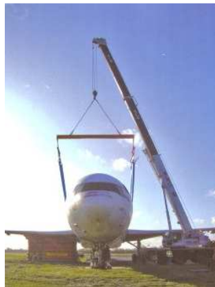
Fig. 4.12 Sollevamento fusoliera (vista frontale)
