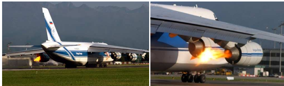
Fig 2.7 Flame out motore 1 e 4
