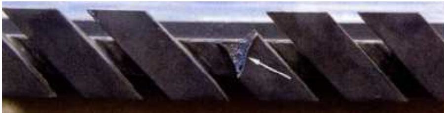
Fig 2.8 Danneggiamento del disco allo stadio 6 del compressore ad alta pressione
