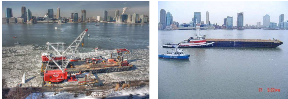
Fig 2.26 Gru adoperata per il sollevamento Fig 2.27 Chiatta per il trasporto del velivolo
