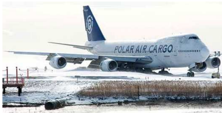
Fig. 5.3 Il sistema EMAS è provato anche in condizioni proibitive
