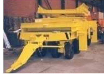
Fig. 4.15 Carrello per il supporto della fusoliera
