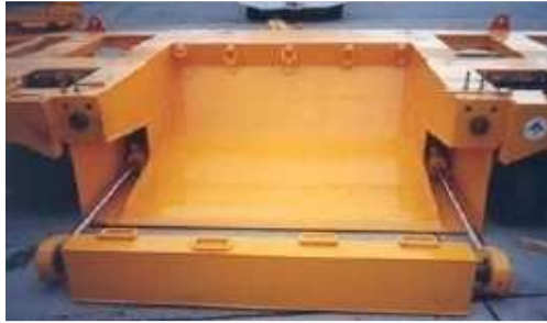
Fig. 4.14 Carrello per il supporto del carrello di atterraggio
