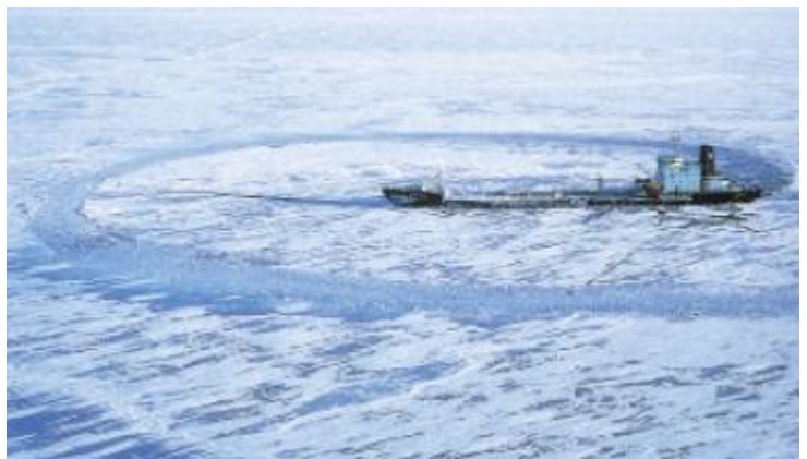
Esempio di manovra con azipod [1.2.f.]
