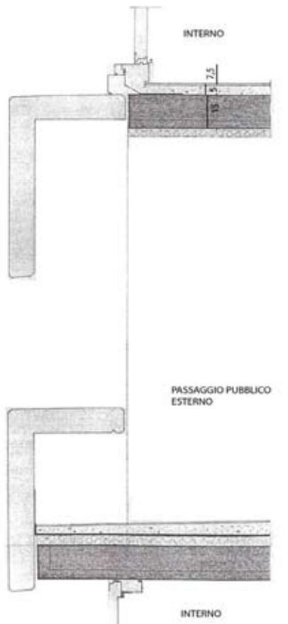
Pareti longitudinali, sezione su passaggio pubblico.
