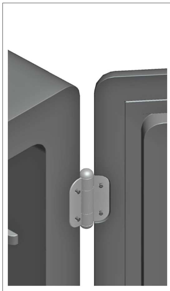
8 – Applicazione della porta reversibile tramite viti 108
