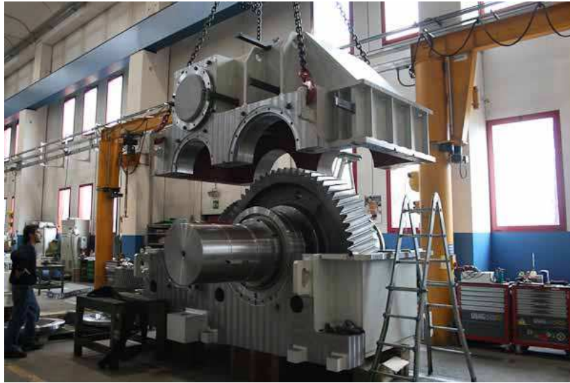
Figura: Riduttore principale per il comando di un mulino di macinazione del cemento
