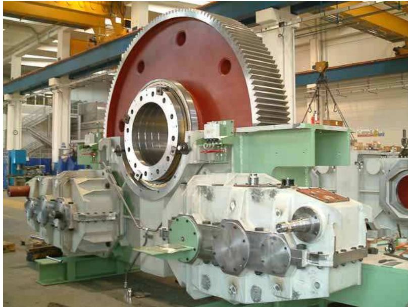
Figura: Riduttore di comando convertitore basculante a quattro motorizzazioni
