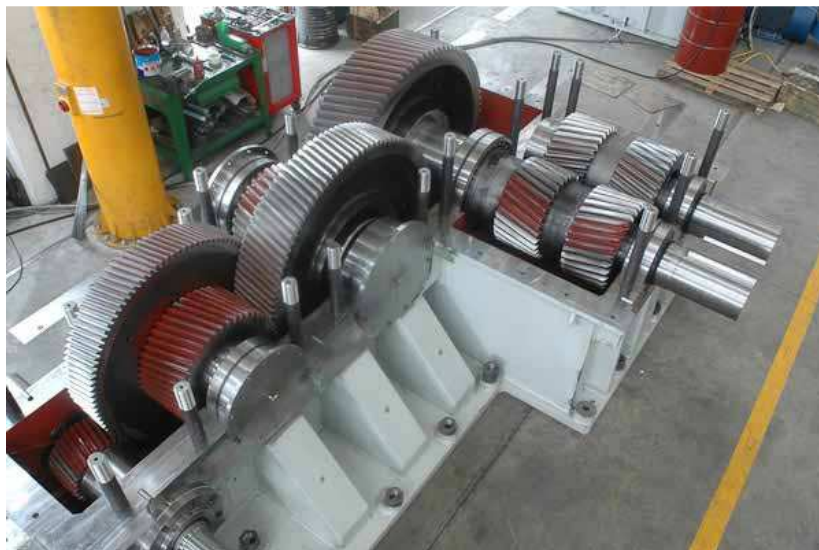
Figura: Riduttore di comando mescolatore gomma per la produzione di mescola per pneumatici
