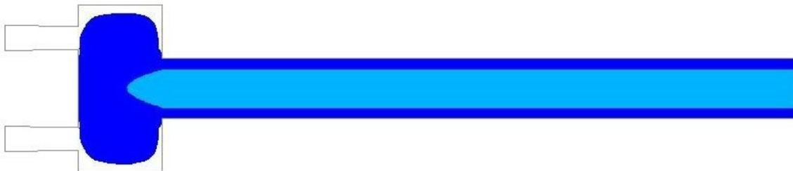
**Figura 4.14 – Mappa colorimetrica della velocità del piano passante per gli ingressi 2 e 4. Portata della parenterale pari a 15 ml/h.**
