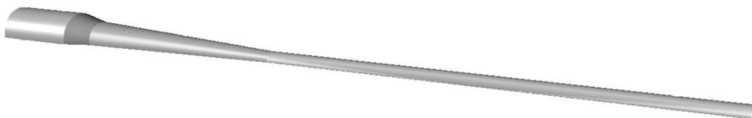
Figura 4.31 – Disegno del dominio del catetere utilizzato per le simulazioni computazionali.
