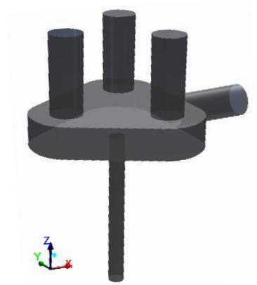
**Figura 4.40 – Rappresentazione tridimensionale della seconda geometria modificata del connettore.**
