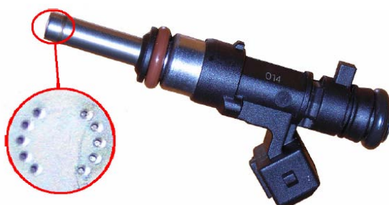
Fig. 2.3: Iniettore BOSCH; particolare sui 10 fori.
