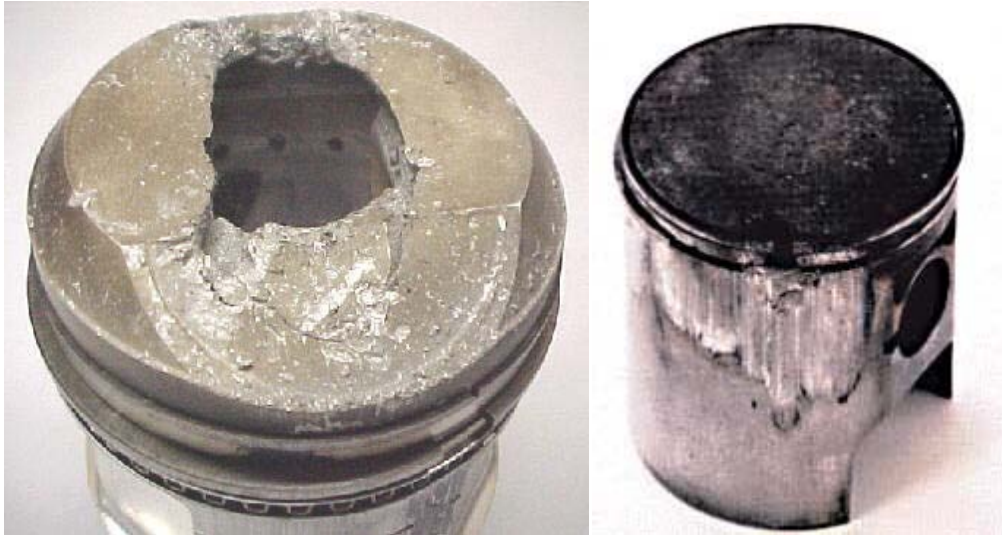
Fig. 1.2: Danni provocati dalla detonazione.
