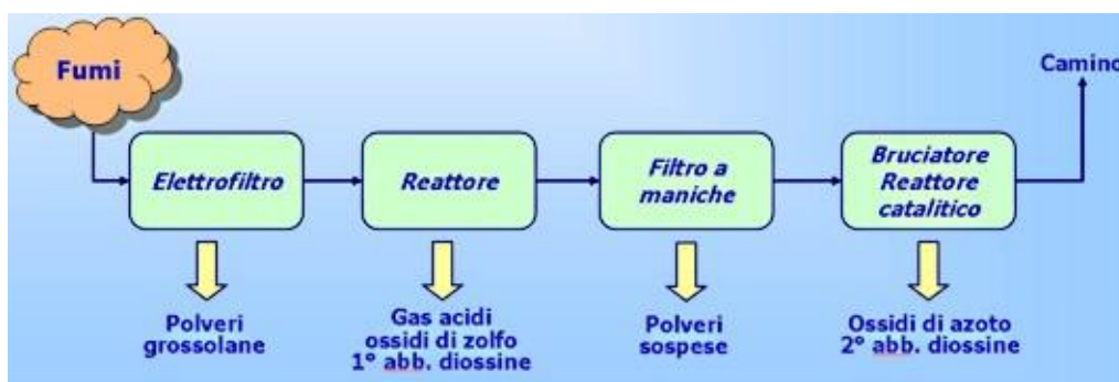
Figura 13. schema di funzionamento impianti trattamento fumi.
