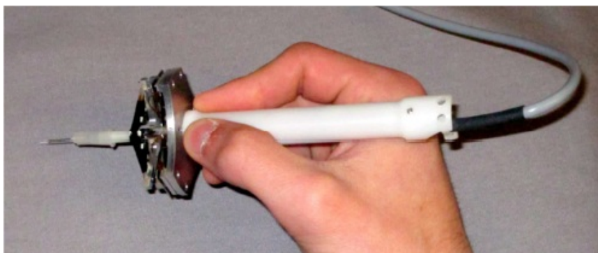
Figura 1.3: Robot chirurgico Micron (figura estratta da [20]). La punta è separata dall'impugnatura da motori piezoelettrici che consentono il movimento indipendente delle due componenti.
