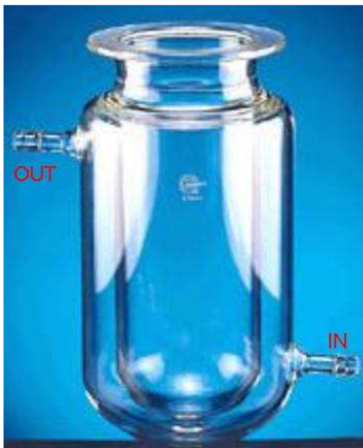
Figura 2-9: reattore termostato in PIREX con camicia esterna. La camera di reazione viene alimentata dei reagenti attraverso l'apertura superiore che può essere anche chiusa con il proprio coperchio. La camicia esterna invece viene riempita di fluido refrigerante o riscaldante che attraverso un collegamento di tubi con un serbatoio e una pompa, viene fatto circolare passando dall'ingresso (apertura IN) all'uscita (apertura OUT).
