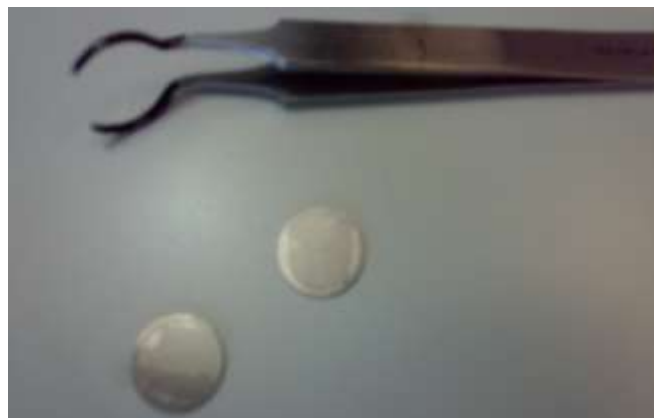
Figura 2-13: supporto portacampione di mica per le analisi all'AFM.
