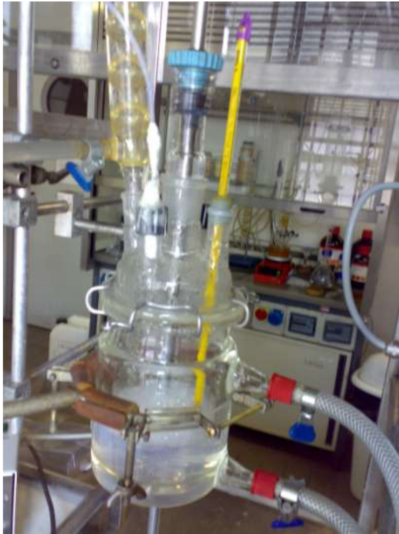
Figura 2-11: reattore termostato per le reazioni in semibatch.
