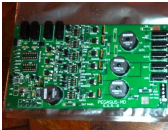
fig. 3.7 - La board a discreti SSR utilizzata per validare gli studi e le simulazioni eseguite da Pegasus Microdesign
