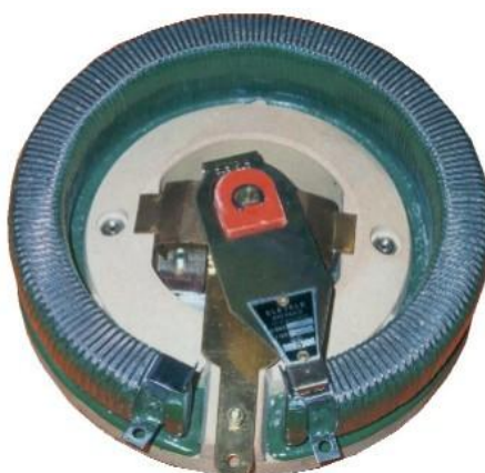
fig. 3.14 - Il reostato è stato utilizzato per simulare un carico variabile e per il tracciamento delle curve
