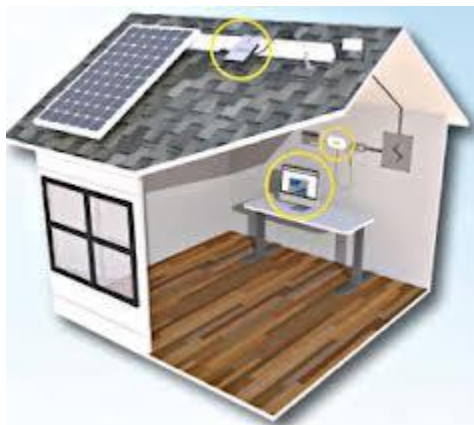
fig. 2.2 - Impianto con microinverter sul tetto, gateway connesso alla rete e pc per il monitoraggio
