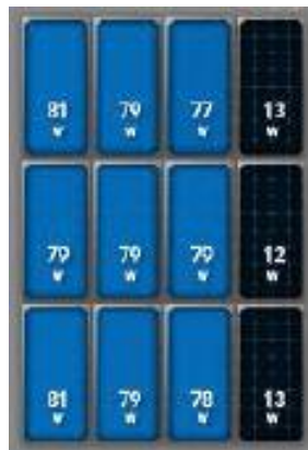
fig. 2.6 - Dal software di monitoraggio si può notare: a) pannelli in condizioni ottimali erogano potenze diverse (mismatch); b) un'ombra fa lavorare l'inverter in condizioni molto lontane dall'ottimo
